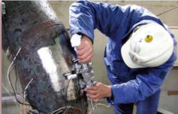
主蒸気・高温再熱／直管・エルボ一部探傷状況
