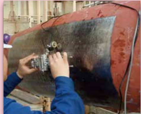
主蒸気・高温再熱／直管・エルボ一部探傷状況
