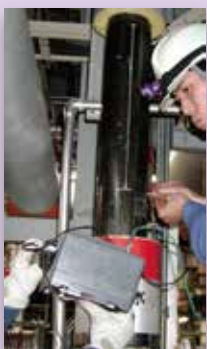
垂直方向配管探傷状況
