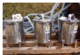
水中のセシウム 吸着除去システム
