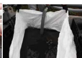
凝集剤添加後 水切り袋で脱水
