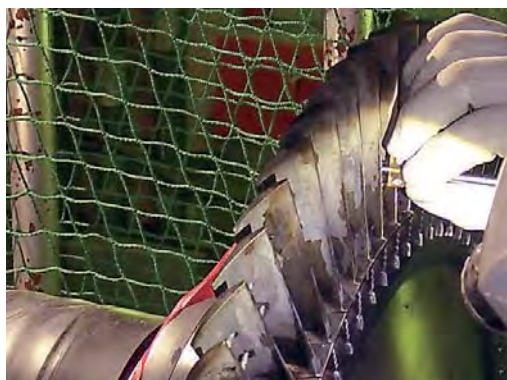
探傷試験風景(フェイズドアレイ法)
