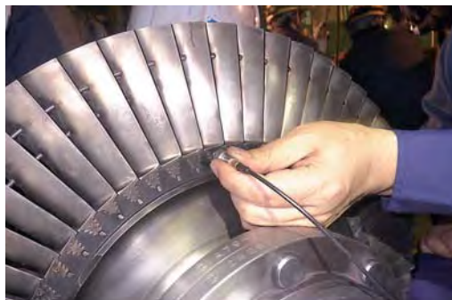
探傷試験風景(垂直法)
